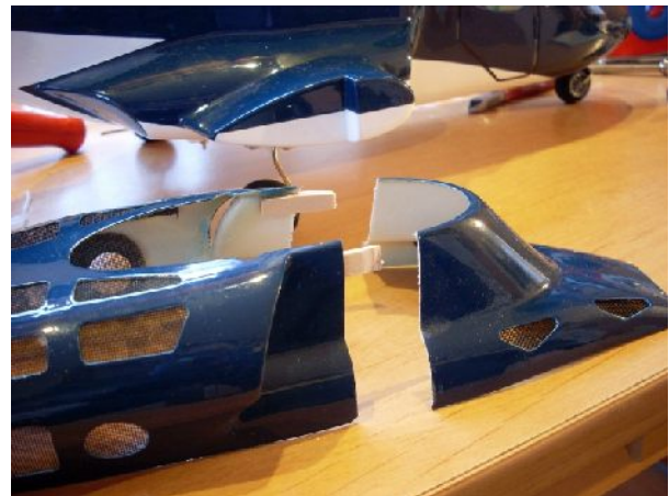
Abbildung 3: Kleben mit UHU 2min 2K-Kleber
